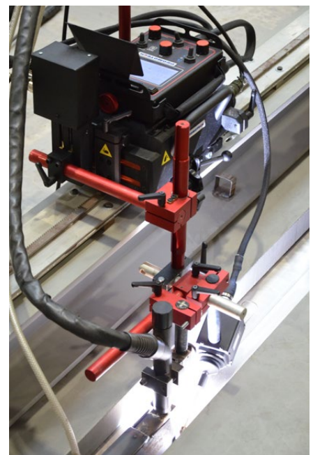
Nahtführung funktioniert mit und ohne Oszillation
