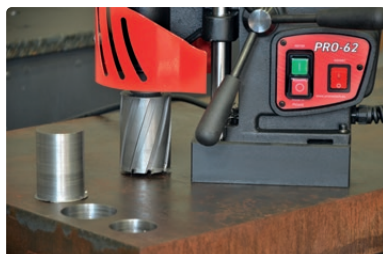
Maximale Schnitttiefe bis zu 75 mm
