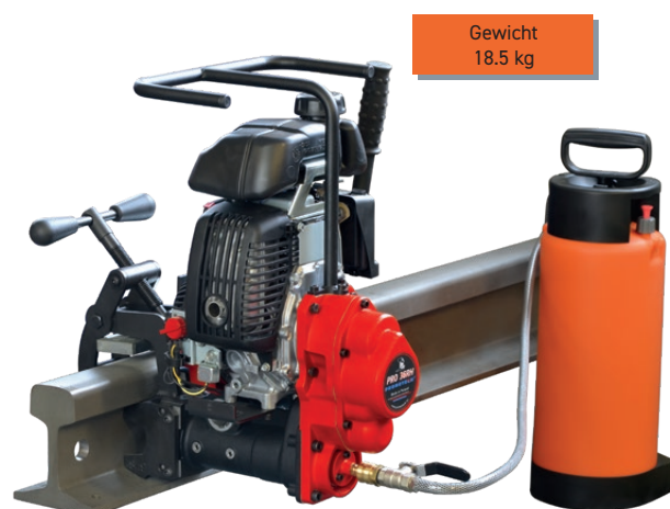
PRO-36 RH ist mit einem Honda Benzinmotor ausgestattet
