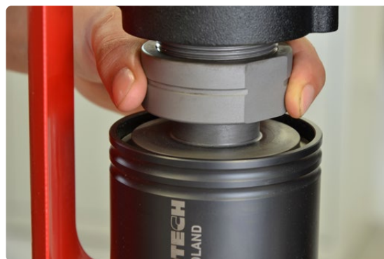
Gewindeschneidfutter mit Sicherungsmutter
