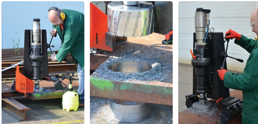
Fräsleistung bis 200 mm
