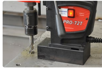
Gewindeschneiden von Sacklöchern bis M20
