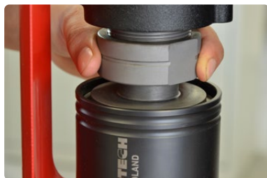
Gewindeschneidfutter mit Sicherungsmutter
