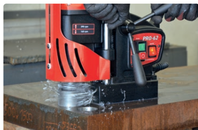
Fräseleistung bis zu 65 mm
