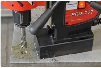
Gewindeschneiden von Durchgangsbohrungen bis M20
