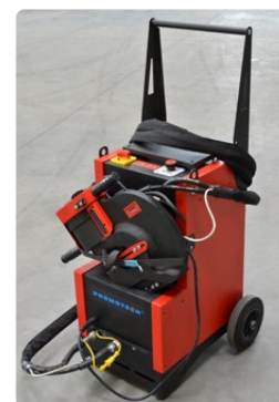
tragbare Hydraulikstation mit Ablage zum Transport der Lochstanze
