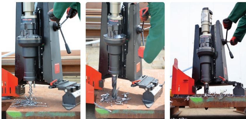
Bohrleistung bis 45 mm
