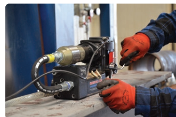
Der Vorschubhebel kann von beiden Seiten fixiert werden
