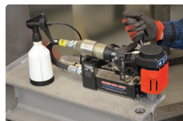
Kühlsystem durch die Spindel
