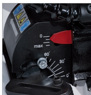
Kontinuierliche Winklereinstellung von 0 bis 60 Grad.
