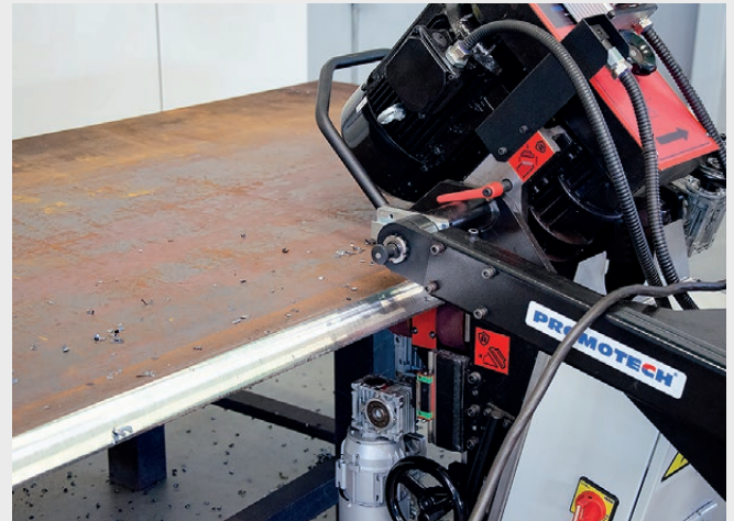
ANFASMASCHINEN FÜR BLECHE
