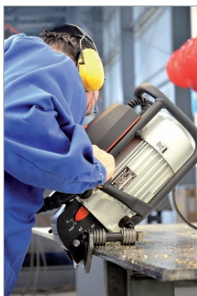
Fasen von Blechen
