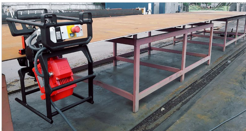
ABM-14 läuft automatisch an der Platte entlang
