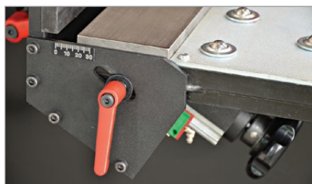
Einfache Einstellung der Fasenbreite
