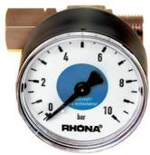
Mit diesem Manometer prüft man, ob die erforderlichen Druckparameter am Maschinenschneidbrenner anstehen
