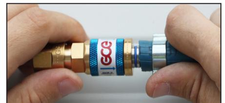
3. Kupplungsvorgang beendet. Der farblich gekennzeichnete O-Ring bleibt sichtbar.
