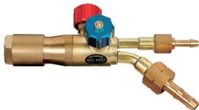
Zum Einspannen, für stationären Betrieb. Durchsatzleistung 30 m<sup>3</sup>/h, Anschluß: Sauerstoff 3/8" mit 6,3mm Tülle, Brenngas 1/2" LH mit 9mm Tülle.
