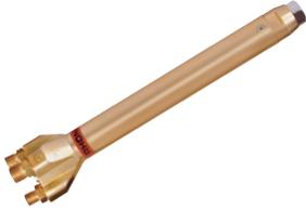
Passend zu den Schneiddüsenpaketen Coolex A-MD und TRITEX. Die Brenntypen BGR 220/320 sind für die Aufnahme von gasemischende Maschinenbrennschneiddüsen mit 30° IC-Konus bestimm. Das äußere Design entspricht dem der Injektor-Brenner und ist wie der BIR äußerst robust und zuverlässig. Schaftlänge 220 und 320 mm.
