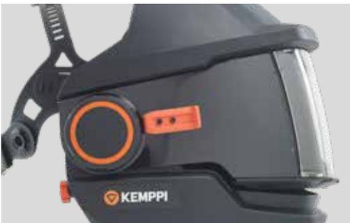
**Der GapView-Schalter öffnet einen 15 mm schmalen Spalt** und ermöglicht so unter dem Schweißvisier hindurch eine klare Sicht auf den Arbeitsbereich. Ideal zur Vorbereitung des Werkstücks und das Setzen erster Heftpunkte vor dem Schweißen. Ausgezeichnetes Merkmal, wenn Lichtbögen an den umliegenden Arbeitsplätzen störende Aktivierungen des ADF auslösen können.
