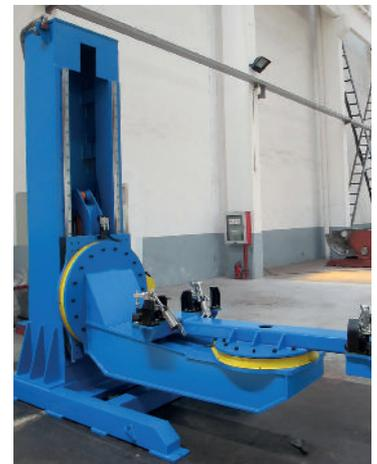
Alle HBL-L Positionierer haben eine Eingangsspannung von: 3P, 400V, 50 HZ
