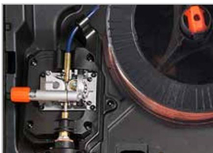
Die Kempact 251-Modelle verfügen über den GTO2C-Drahtvorschub mit zwei Rollen.
