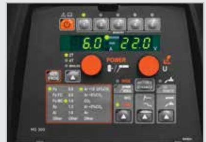
Die synergischen FastMig M Pakete umfassen ein MS-Bedienpanel, das einfach zu bedienende synergische Funktionen sowie eine große Auswahl zusätzlicher Möglichkeiten bietet, um Ihre Schweißarbeiten zu optimieren. Diese Pakete eignen sich für den professionellen Einsatz bei anspruchsvolleren industriellen Anwendungen.
