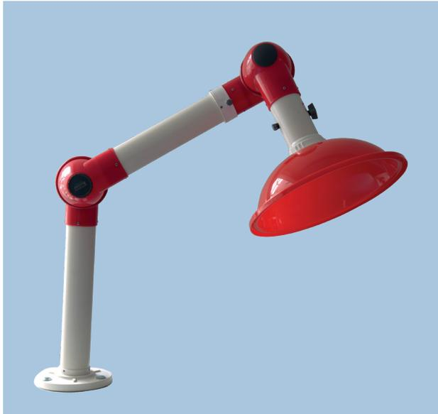
Der Absaugarm Typ LA-2-S ist aus säurebeständigen Materialien (PP und Edelstahl) gefertigt. Durch den Flanschanschluss kann er direkt auf einen Tisch montiert werden und ist um 360° drehbar.
