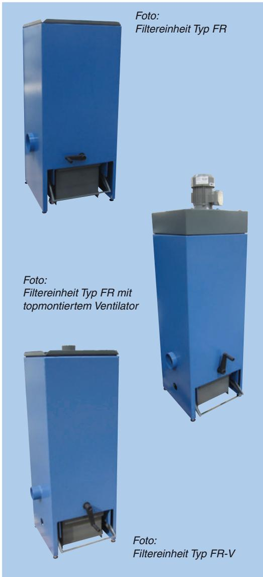
Kompakte Filteranlage mit manueller Roto-Reinigung. Geeignet für Filtration von Luft von staub- und spänehaltigen Prozessen mit kurzen Betriebszeiten, z.B. in Verbindung mit Schleifmaschinen und kleineren Strahlkabinen. Ist lieferbar mit montiertem Ventilator Typ VT 500 (für FR 3) oder VL 750 (für FR 5) oben auf der Anlage.
