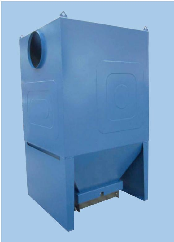
Wird als Vorabscheider vor Filtration der Prozessluft verwendet, die eventuell Funken beinhaltet, dies kann der Fall sein, wenn es ein relativ kurzer Weg vom funkenerzeugenden Prozess, z.B. Schleifen, Plasma- oder Brennschneiden, bis zur Filteranlage ist. Im Vorabscheider mit Funkenfang Typ FUV werden mögliche Funken durch Labyrinth mit Wasser gelöscht.
