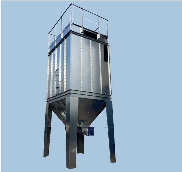
Die Schlauchfilteranlage Typ V-FPM ist aus verzinktem Stahlblech gefertigt. Die Anlage ist für ATEX Anwendungen für die Zone 22 3D ausgelegt.
