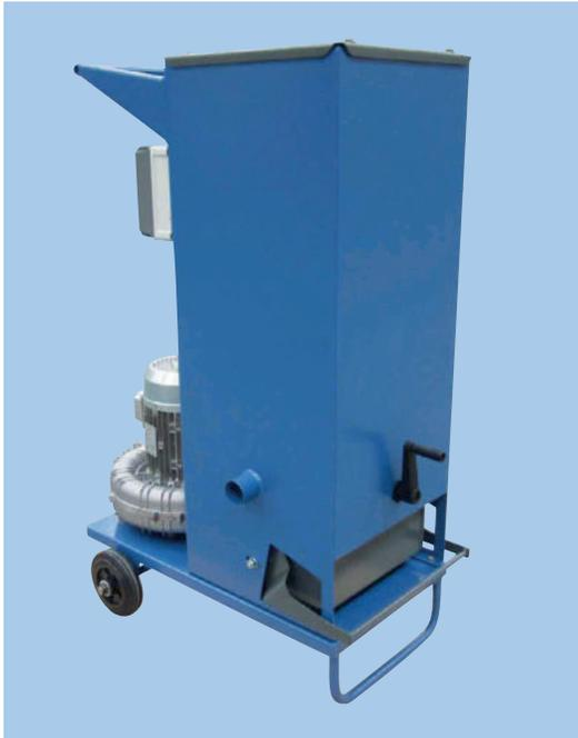
Der Hochdrucksauger ist hervorragend zur Reinigung und Absaugung von Staub und Spänen von z.B. handgehaltenem Elektro- und Druckluftwerkzeug oder kleinen stationären Maschinen.
