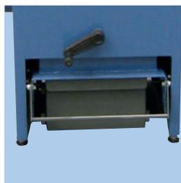
**Einfache Entleerung des Staubbehälters**
