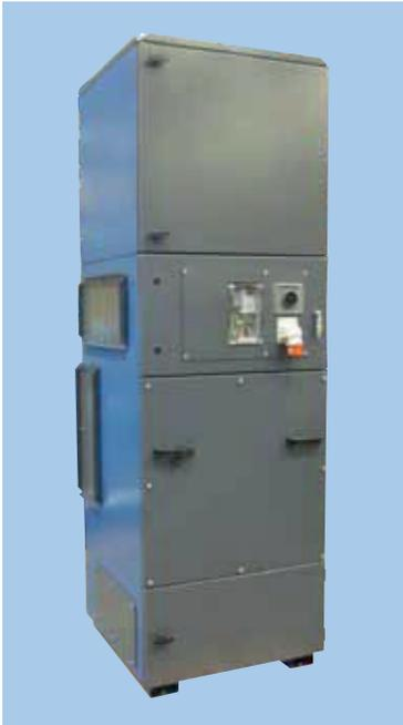
Komplette und platzsparende "Plug & Play" druckluftgereinigte Filteranlage mit integriertem Ventilator, die zur Luftfiltration von Prozessen angewandt wird, die begrenzte Staubmengen (Schweißen, Schneiden, Schleifen u.ä.) bilden. Kann in den Produktionsraum gestellt werden und bis zu 7 Schweißplätze gleichzeitig absaugen.
