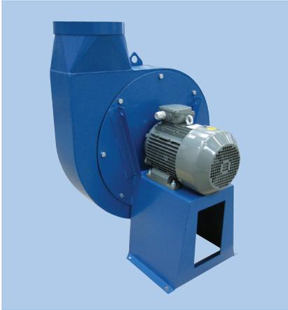
Zentrifugalventilator mit geschlossenem Ventilatorrad, der für Punktabsaugung von verschmutzenden oder späneerzeugenden Arbeitsprozessen angewandt wird. Transportierte Luft darf nicht klebende oder klebrige Dämpfe oder Staub enthalten.
