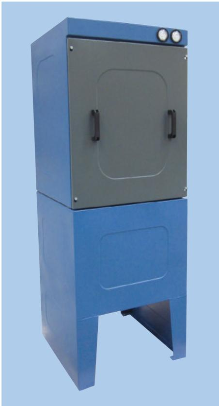
Stationäres Filtergehäuse mit der Möglichkeit mehrerer Filterstufen, Standard mit Kompakfilter F9 sowie 2 Stück Minihelic-Differenzdruckmanometer ausgerüstet. Einschl. Aufhängung für HEPA-Filter mit dem Maß 610x610x292mm.
