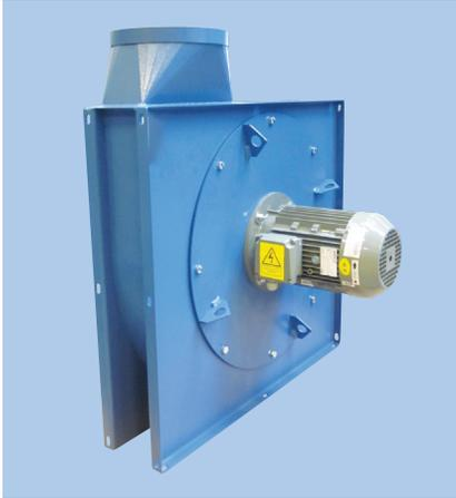
Zentrifugalventilator mit geschlossenem Ventilatorrad, welcher für Punkt-absaugung von verschmutzenden oder späneerzeugenden Arbeitsprozessen angewandt wird. Transportierte Luft darf nicht klebende oder klebrige Dämpfe oder Staub enthalten.
