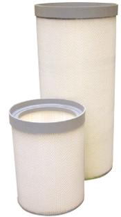
Die Filter erfüllen Forderungen zum Abscheidegrad für Staubklasse M gemäß DIN EN 60335-2-69 Anhang AA (Abscheidegrad > 99,9%).
