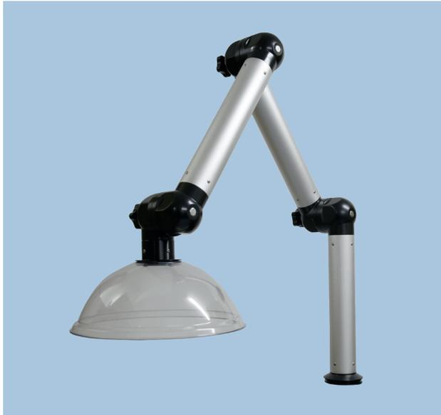
Der Absaugarm Typ LA-3-ST ist aus eloxiertem Aluminium hergestellt. Er wird vorwiegend in Laboren eingesetzt. Durch den Flanschanschluss kann er direkt auf einem Tisch montiert werden. Eine Konsole zur Tisch- oder Wandmontage ist optional erhältlich. Der Arm ist mit einer Klarsicht-Trichterhaube ausgestattet. Durch die durchgängige Ausführung aus Metall ist eine Erdung möglich.
