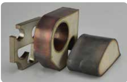
Glatte Schnittflächen | Smooth cut surfaces
