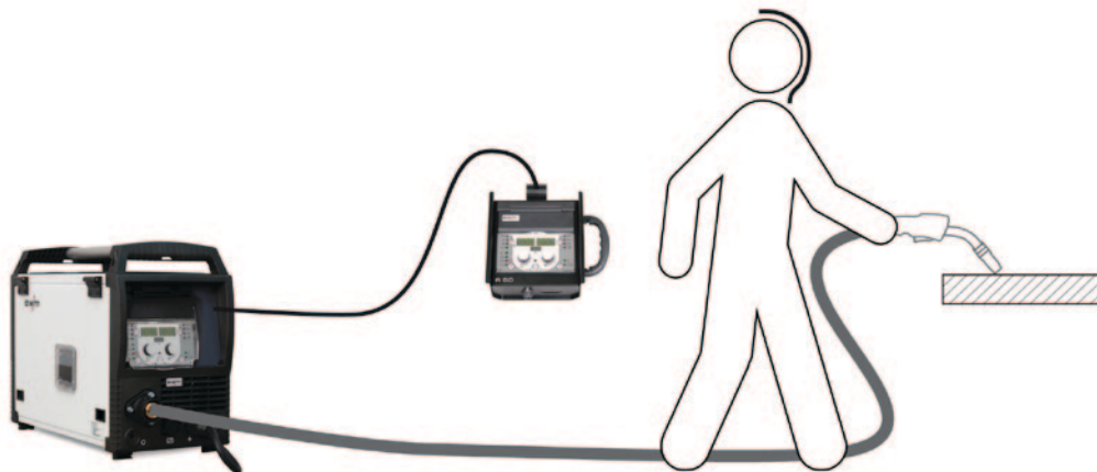
R50 7POL als zweite mobile Bedienung mit Kompaktschweißgerät
