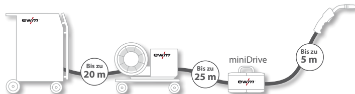
Systembeispiel: Dekompaktes Schweißgerät + Drahtvorschub + miniDrive
