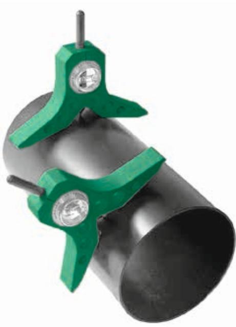
Mit Gradeinteilung und Winkelmesserlibelle zum Ankörnen der Lage von Mittellinien und Abgängen an Rohren und Tanks unter beliebigen Winkeln. **Bestimmen** des Neigungswinkels, **Einstellen** von Winkeln, **Mittelpunkt suchen** an Rohren, **Nivellieren** beim Aufstellen von Tanks u. ä. Die Winkelmesserlibelle mit Gradeinteilung ist verstellbar, so dass Winkel und Neigung ohne umzurechnen leicht einstell- und ablesbar sind. Material: Aluminium eloxiert. Körner: Werkzeugstahl, gehärtet.
