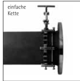
Zum Zentrieren und Spannen von Langrohren ohne Längenbegrenzung sowie von Rohrbögen, T-Stücken, Flanschen, Reduzier- und sonstigen Formstücken an Rohre und Behälter. Die flexiblen CENTROMAT®-Außenzentrierketten passen um jedes Rohr und jeden Behälter. Sie lassen sich durch einfaches Auswechseln der Ergänzungsglieder beliebig verlängern oder verkürzen. In 5 Ausführungen lieferbar in Stahl, galvanisch verzinkt oder Edelstahlausführung.
