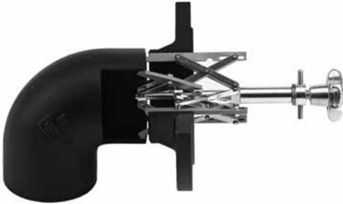
Unabhängig voneinander spannbare Spreizkörper. Für Rohrbögen und Krümmer aller Radien. Schnelle, sichere Handhabung ohne weitere Hilfe: die „dritte Hand“ ist überflüssig – der untere Spreizkörper der Zentriervorrichtung wird im Rohrbogen so weit gespannt, dass die Vorderkanten des oberen Spreizkörpers an der Stirnseite des Rohrbogens anliegen. Der Flansch o. ä. wird auf den oberen Spreizkörper aufgesetzt und gespannt. Auch für Glattflansche. **Automatischer Durchmesseranpassung.**
