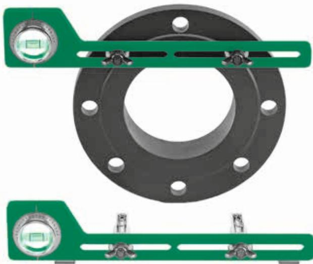
Mit verstellbarer Winkelmesserlibelle und verschiebbaren Passbolzen. Die Passbolzen passen in Flanschlöcher für alle gängigen Durchmesser, wodurch die anzuschweißenden Flanschen genau ausgerichtet werden. Winkel und Neigung sind ohne umzurechnen leicht einstell- und ablesbar. Material: Aluminium eloxiert.
