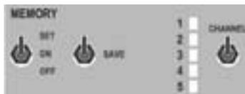
SELECTO ist der Name für eine Funktion, in der die Schweißparameter in die memorykanäle eingespeichert werden können. Man kann in den memory 5 St MIG/MAG-Schweißwerte einspeichern. Die einzuspeichernden Parameter sind Drahtvorschubgeschwindigkeit, Schweißspannung und Schweißdynamik. Die eingespeicherten Werte bleiben im memory, auch wenn die Anlage aus- und eingeschaltet wird.
