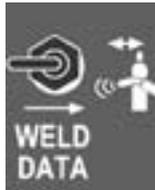
Verwendung des WELD DATA-Tasters bringt im Display die Schweißparameter, Draht vorschubgeschwindigkeit, Schweißstrom, Schweißspannung, zu dem Zeitpunkt, als das Schweißen gestoppt wurde. Die Schweißwerte sind so lange in der Anzeige sichtbar, wie der WELD-DATA-Schalter gehalten wird, und bleiben im Speicher, bis der Taster des Brenners erneut gedrückt wird.
