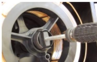
**Achtung! Überprüfen Sie, daß der Schweißdraht oder die Drahtspule nicht das Gehäuse berührt, es besteht die Gefahr eines Kurzschlusses!**
