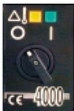
In der Stellung I liegt an den Steuerkreisen des Geräts Spannung an. Die Kontrollampe des Hauptschalters leuchtet und die Stromquelle ist betriebsbereit. Die Kontrollampe leuchtet immer wenn die Maschine an Netzspannung angeschaltet ist und der Hauptschalter in der Stellung I liegt. Das System geht zurück zu dem Schweißprozess, der vor dem Ausschalten verwendet wurde.
